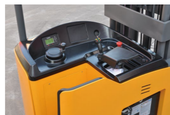
Контроллер и дисплей Curtis 36-вольтовая система управления CURTIS AC обеспечивает надёжность аккумуляторной системы. Многофункциональный дисплей для отображения полной информации о работе машины
