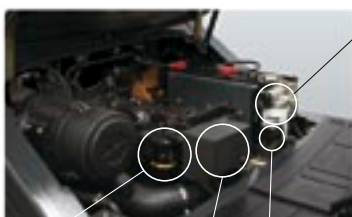
Блоки реле и предохранителей расположены в одном месте
