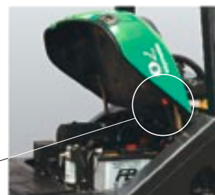
Фиксация капота двигателя обеспечивает безопасное обслуживание
